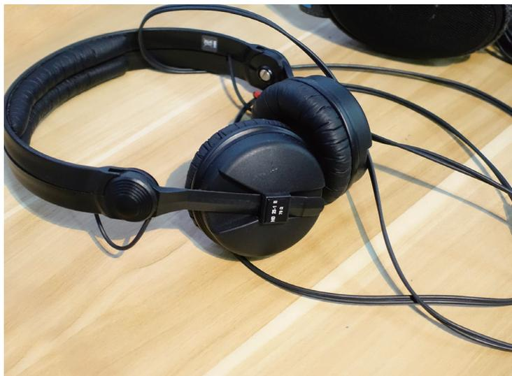
HD25 拥有坚固得近乎牢不可摧的结构，但所有的易耗件，包括线材、耳罩和头垫都可更换，很多使用多年的耳机换上新的易耗件后立刻如获新生。尤其是线材，由于 HD25 上市时间长保有量极大，因此无论原厂抑或线材专业厂都提供了丰富的选择。HD25 的线设计很特殊，单边入线后，左单元的长线可以嵌进头梁里。这样的卡线方式，优点是方便换线，缺点则是需要定制分线后左长右短的专用线材。
